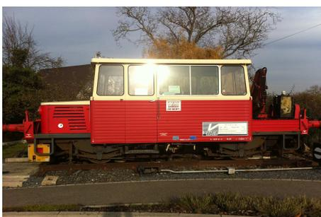
Elle fonctionnait avec un moteur Renault diesel, était employée pour l'entretien, la propreté et la surveillance des voies ferrées. Elle comprend des équipements
